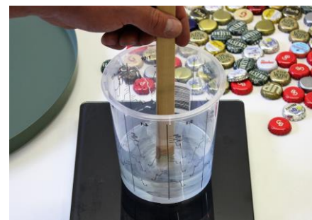
Fig. 3 De A en B component worden (in de juiste verhouding) goed gemengd.
