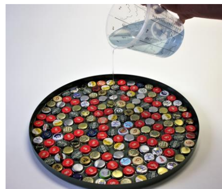
Fig. 6 De epoxy wordt met een dunne straal in het midden gegoten.
