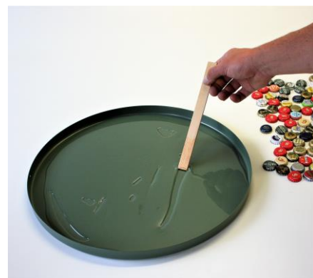
Fig. 4 De epoxy wordt met een spatel over het blad verdeeld.
