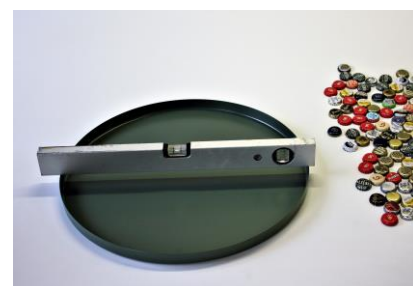
Fig. 2 Het blad van het tafeltje wordt waterpas gelegd.
